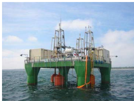
Plataforma de ensayo Buldra (SEEWEC) en pruebas en aguas Noruegas a escala 1/3 del Atlántico
